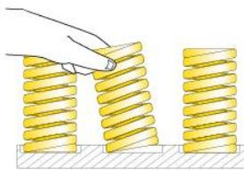
**RUS** Несбалансированная нагрузка, вызванная разрушением одной из пружин, может привести к повреждению других пружин. В этом случае следует заменить все пружины. Соблюдение правил технического обслуживания позволяет сохранить качество и срок эксплуатации пружин, а также избежать возникновения неисправностей производственного оборудования
