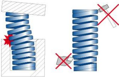
**RUS** Любые механические повреждения пружины значительно снижают срок ее эксплуатации. Поврежденные пружины следует заменять новыми.
