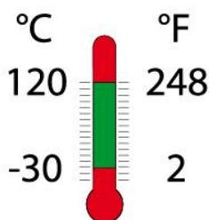
**RUS** Рекомендованный рабочий диапазон температур от -30°C до +120°C. В диапазоне от 120°C до 250°C жесткость пружины будет снижаться на 1% с шагом в 640°C.
