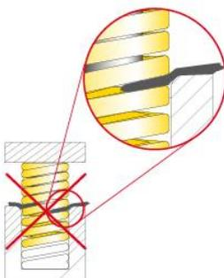
**RUS** Попадание посторонних предметов между витками приводит к преждевременному выходу из строя пружин.
