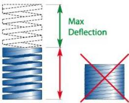
**RUS** Не превышайте максимально допустимый ход пружины. Это может вывести пружину из строя. Не храните пружины в сжатом состоянии в течении длительного времени, поскольку это может вызвать несоответствие заявленных данных с фактическими.
